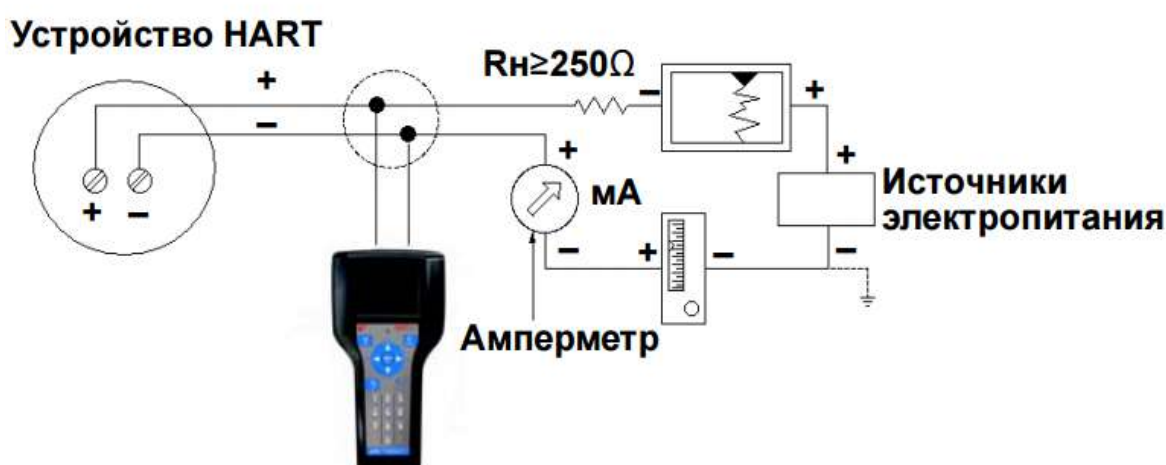
Рисунок 10 - Схема подключения HART-коммуникатора
